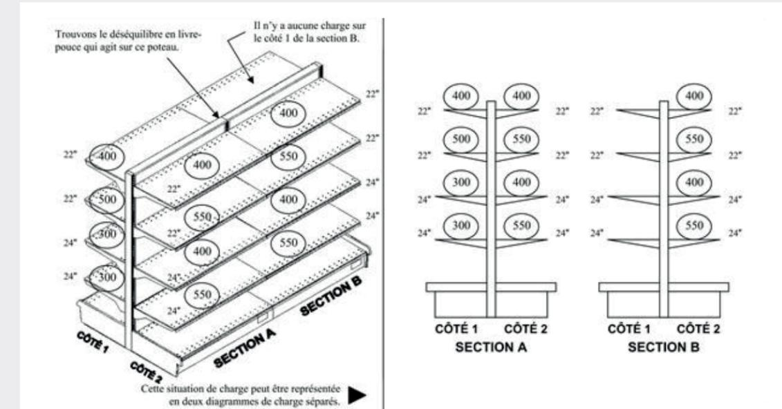
NOTE : La profondeur de la tablette est divisée par 2 car la distribution égale de la charge est calculée au centre de la tablette.
